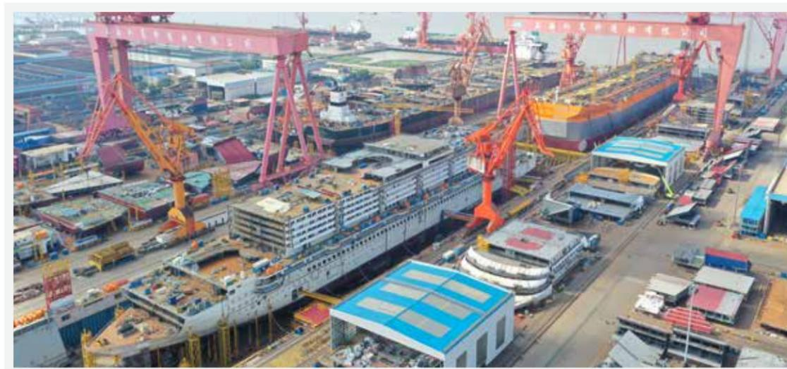
经过接长改造的二号船坞是夯实外高桥造船大型邮轮项目在高质量发展战略中主体地位的关键坐标，也是推动实现“打造中国人自己的大型邮轮”的梦想孵化器。目前，二号船坞内已相继实现了H1508船的26个总段和分段、柴油机和主发电机搭载舾装以及单线两条散货船整船出坞。今天，为后续两艘大型邮轮同时建造提供重要保障的中间坞门也在坞内顺利通过验证。
