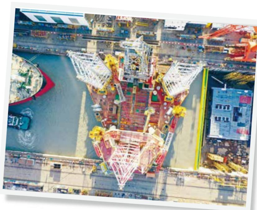
H1349平台出坞完整性较系列平台相比有大幅提升，是外高桥造船首个进行坞内称重试验，并且出坞后直接拖航至外高桥海工临港码头的JU2000E自升式钻井平台。
