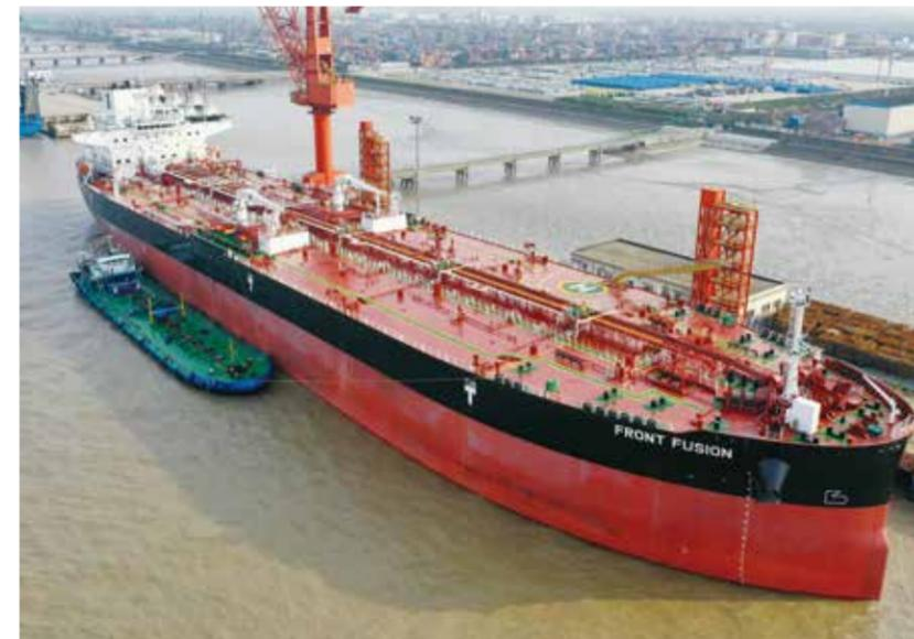
米，型宽44.00米，型深21.20米，设计航速14.5节，满足TIER III 和HCSR规范，入级LR船级社，满足冰区加强ICE 1C，可以装载原油及成品油。
